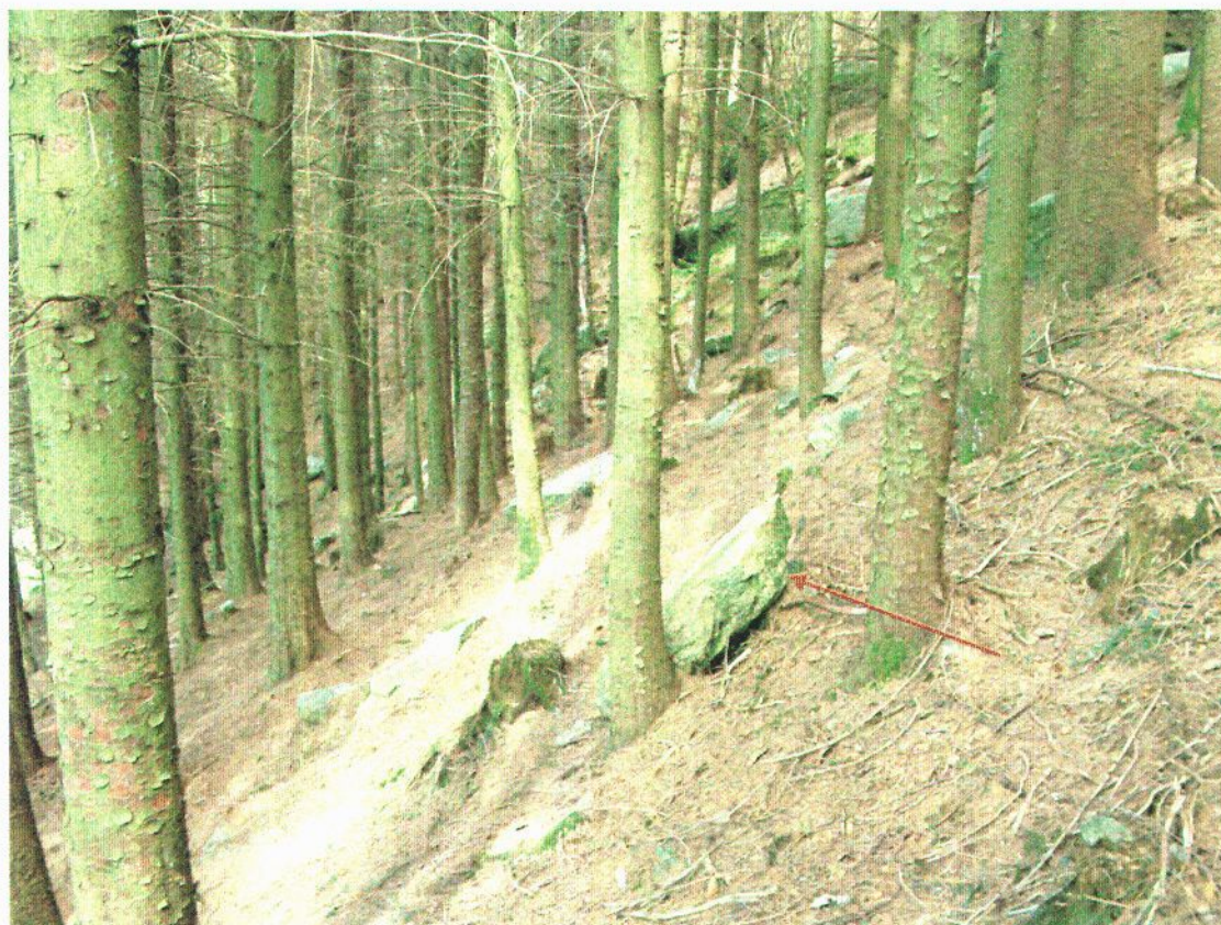
Bilde 4 Løse blokker i skråningen øst for nummer 38. Her har blokkene blitt bremset/stanset i trær.
