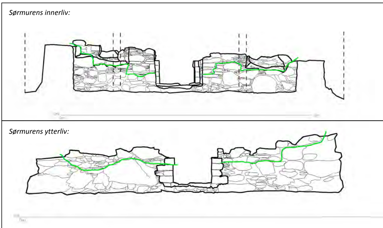
Figur 14: Skillet mellom to typer påvist kalkmørtel i ruinens sørmur. Over den grønne linjen ble det påvist intakt kalkmørtel datert til første halvdel av 1300-tallet. Under den grønne linjen er det murt med en kalkmørtel som er fullstendig utvasket. Restene etter denne mørtelen er datert til andre halvdel av 1200-tallet.
