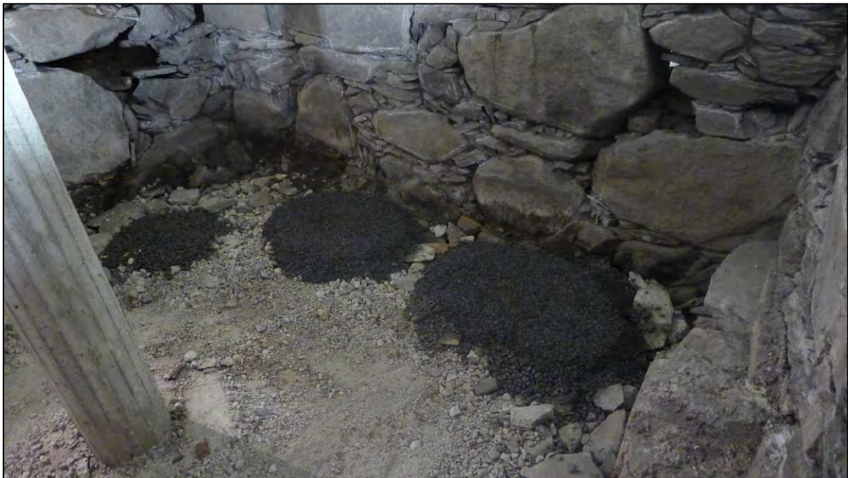
Figur 19: Grusprøver ble lagt ut inne i ruinrommet for å vurdere hvilken kombinasjon av grusstørrelse som fungerte best. Konklusjonen var at prøven lengst til høyre med 8-16mm under og 2-4mm over fungerte best (Foto: Bergen kommune, Byantikvaren 2013).
