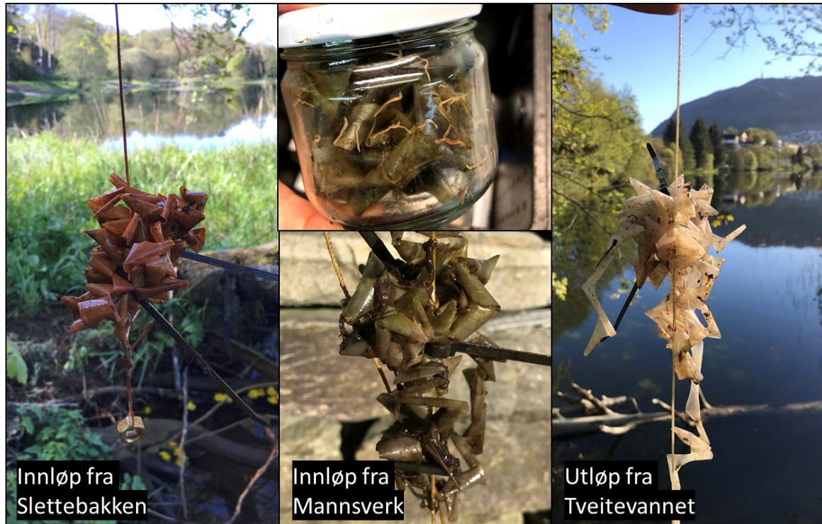
Figur 16 POM ved opphenting fra innløp Slettebakken, innløp Mannsverk og utløp Tveitevannet. Prøvene ble oppbevart i kjøleskap frem til overlevering til lab. I prøveglasset til POM innløp Mannsverk hadde det kommet ut flere levende marker fra strimlene gjennom tiden i kjøleskapet.
