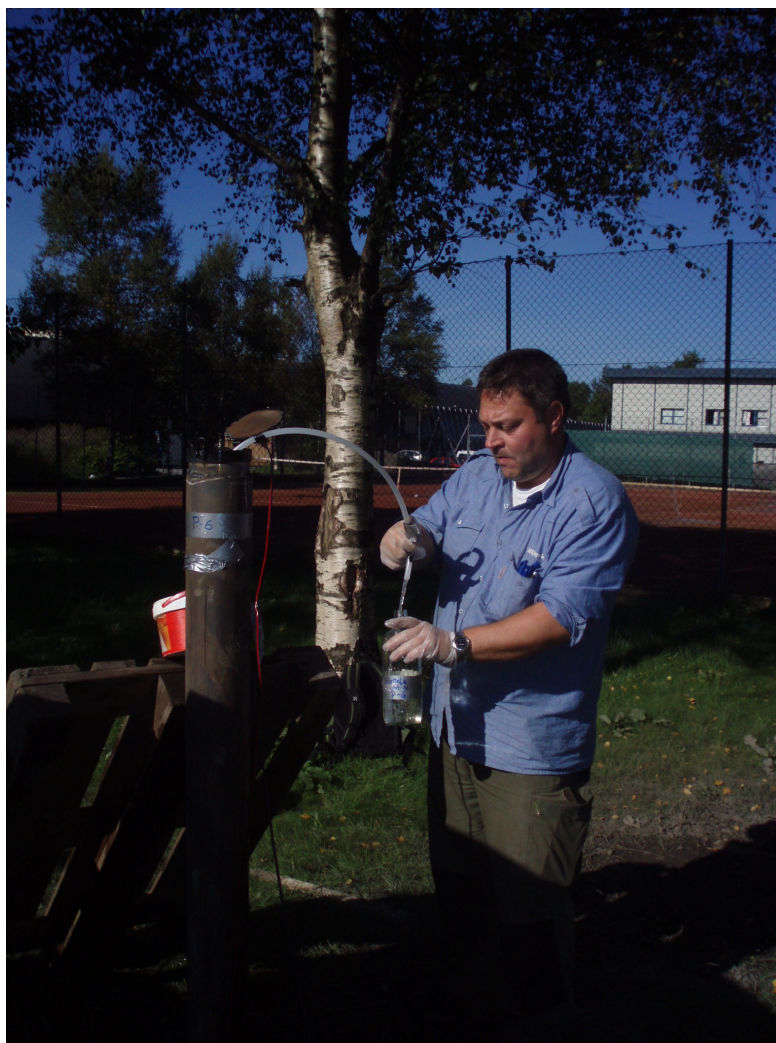
Figur 18. Pumping av grunnvannsprøve fra P6 på Slettebakken – september 2006
