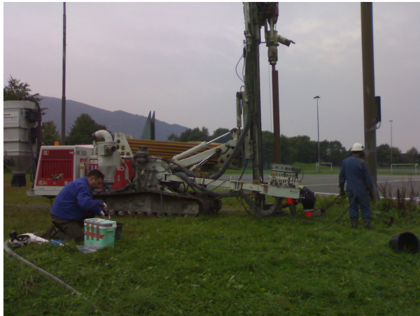
Figur 17. Boring med uttak av masseprøver på Slettebakken – september 2006
