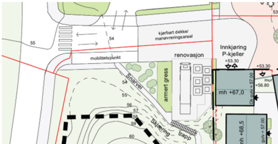
Figur 3 - Utsnitt fra illustrasjonsplan som viser renovasjonsløsning og innkjøring til P-kjeller.
