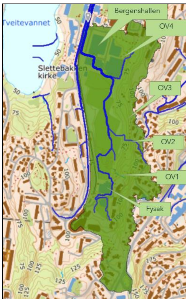
Figur 3-11 Nedbørfeltet ved Slettebakken er vist med grønt. Blå linjer er avrenningslinjer (nedslagsfelt på 1 hektar og større).
