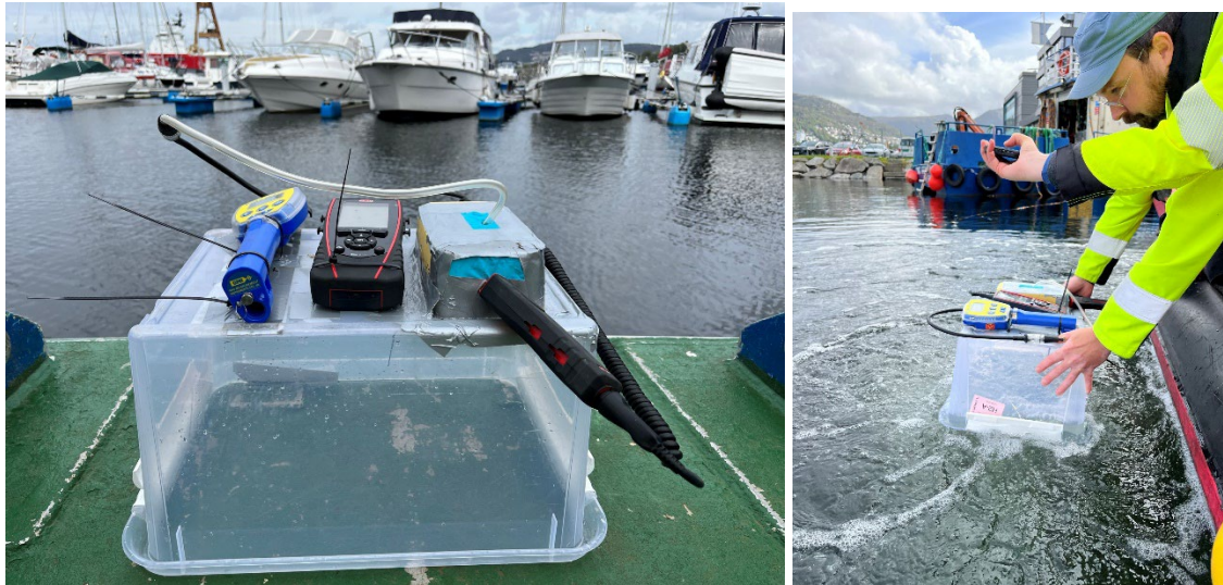
Figur 4: Boks med gassensorer ble plassert i overflaten for å fange gassen som steg opp etter at dykkeren stakk hull på gassformasjonene i matten.
