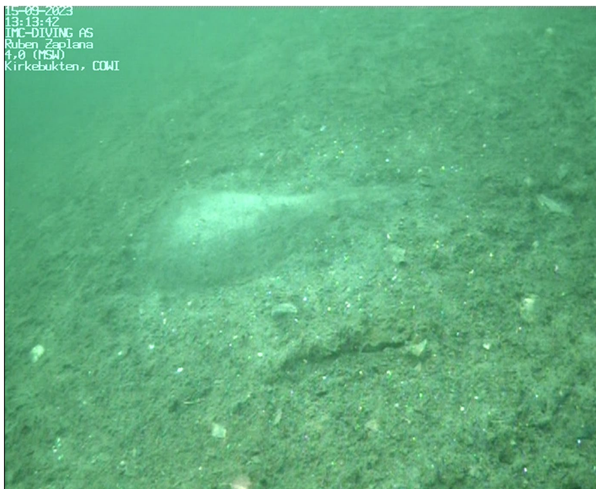
Figur 11: Eksempel på gassansamling under den reaktive matten i felt 1, Kirkebukten.
