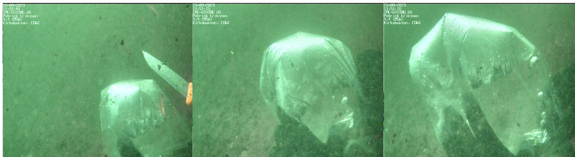
Figur 5: Oppsamling av gass i plastpose direkte over hull i den reaktive matten.
