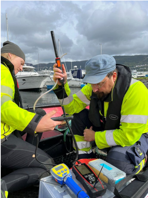
Figur 8: Målinger i luften over lettbooten av gass som strømmer opp etter at dykkeren har stukket hull på matten.
