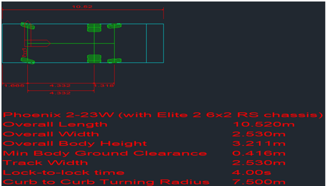
Figur 6 - Målsatt illustrasjon av kjøretøy benyttet til sporingsanalyse.
