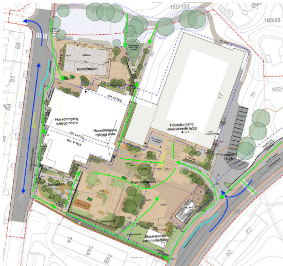
Figur 4: Utsnitt av illustrasjonsplan som viser ferdslelinjer for gåande (grøne linjer) og køyremønster for biltrafikk (blå linjer).
