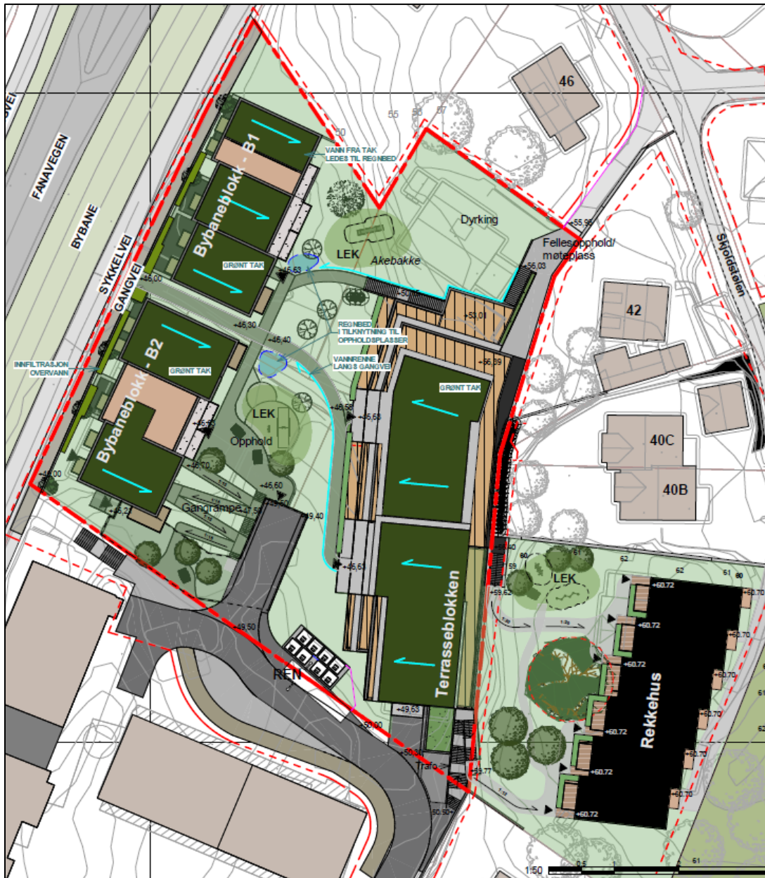
Figur 63. Prinsipp for overvannshåndtering etter utbygging. (Sweco Archtiects)
