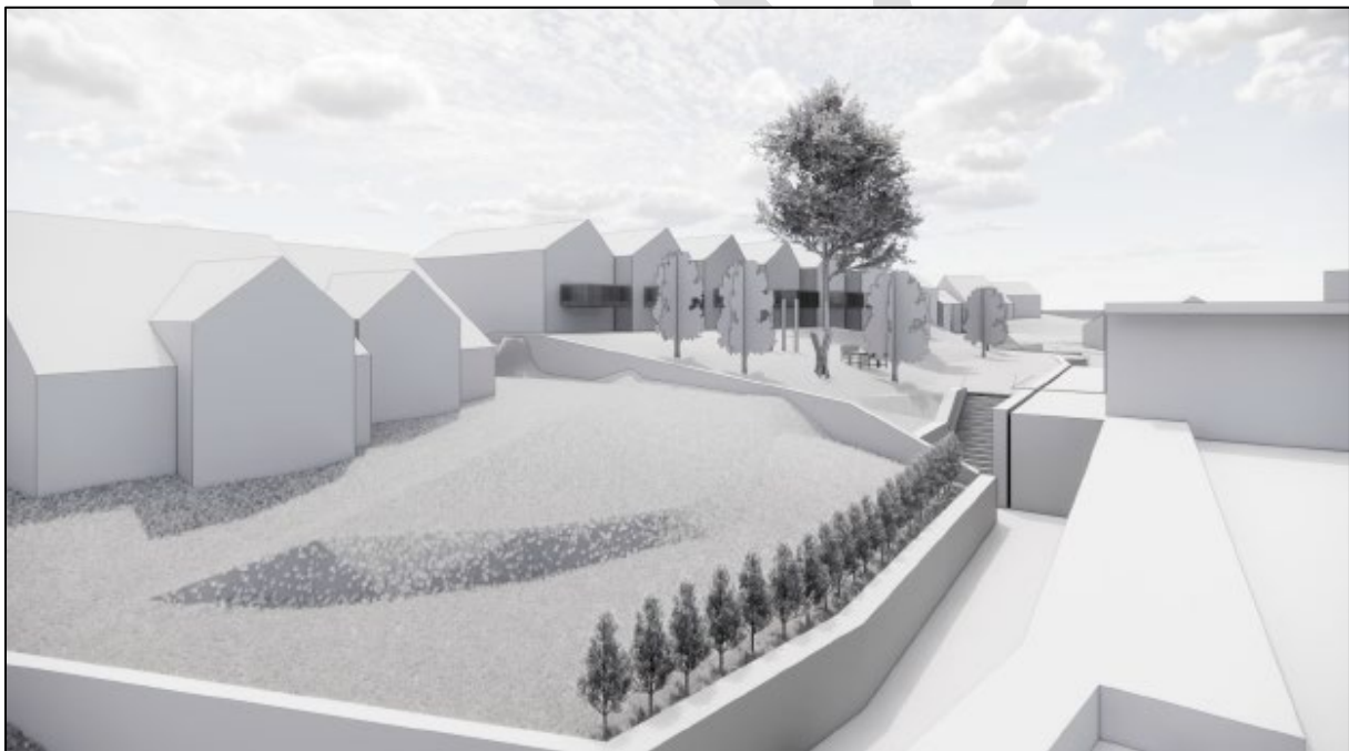
Figur 97. Baksiden av terrasseblokken mot naboer. Tomter skilles med mur og vegetasjon. Maks tillat høyde på mur er 1,5 m. Gangarealet kan ikke overdekkes for å sikre avstand fra nytt bygg til nabo. Kilde: SWECO Architects
