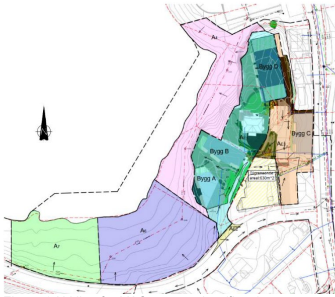
Figur 48 Utklipp fra VAO-rammeplan (fig. 5), overvannssoner og fall/avrenning.
