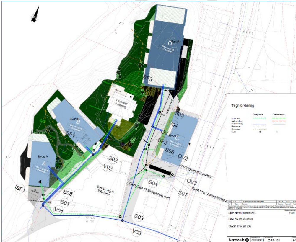
Figur 44 Utklipp fra vedlegg i VAO-rammeplan, 21.12.2023. Oversiktskart over VA-ledninger, eksisterende og nye. Etablering av SP160 og VL150 medfører tiltak i offentlig veggrunn.
