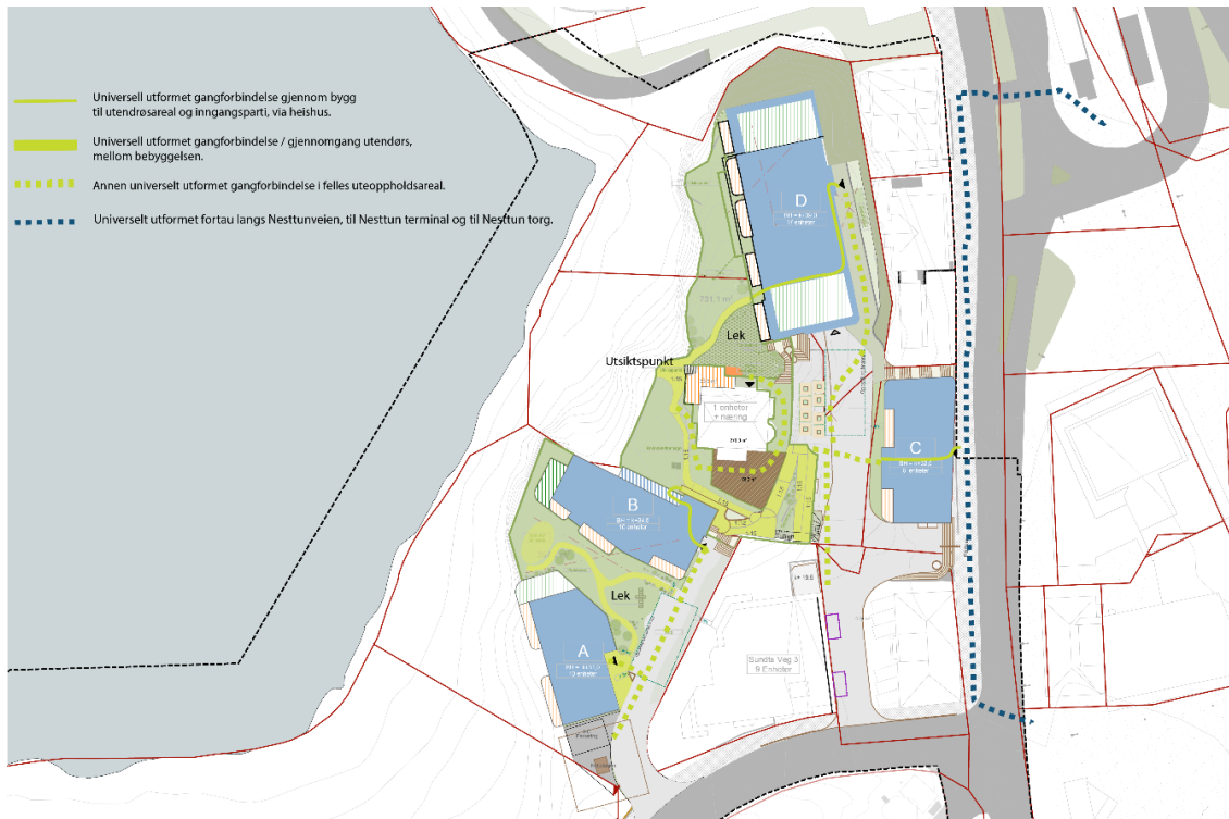
Figur 34 Prinsipp for tilgjengelig adkomst og universell utforming mellom bebyggelse og renovasjonsanlegg og i uterom (ref. grønn ganglinje) samt via bygg C til Nesttunveien og derifra til Nesttun terminal og til Nesttun torg (ref. blå ganglinje).
