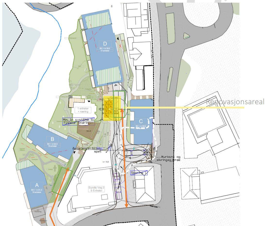
Figur 41 Skisse som illustrerer renovasjonsløsning samt adkomst for varelevering og utrykningskjøretøy (orange pil). Brannoppstillingsplass vises med grønt omriss. Alternativer for varelevering til bygg C illustreres med hvit stiplet linje og piler fra et tentativt utleverings- / oppstillingspunkt (hvit sirkel). Kartbakgrunn er tidligere utkast av illustrasjonsplan.
