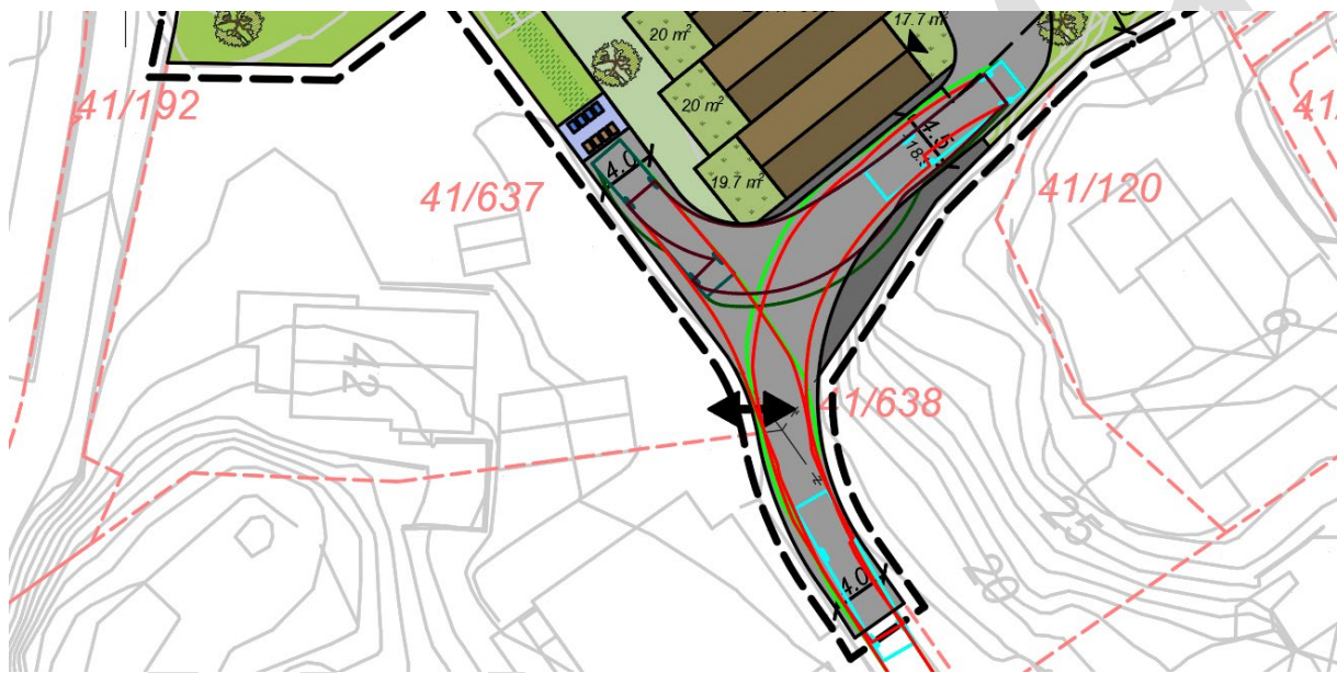
Figur 39: Illustrasjonskart der sporingskurver for renovasjonsbil er inntegnet.
