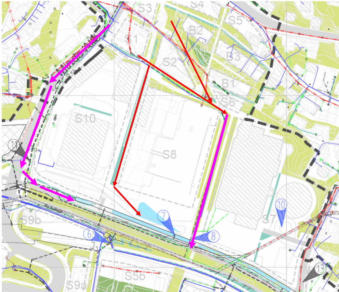
Figur 10 Flomvei over i Minde Allé avskjærer oppstrøms overvann. S10 vil ha avrenning til kanal.
