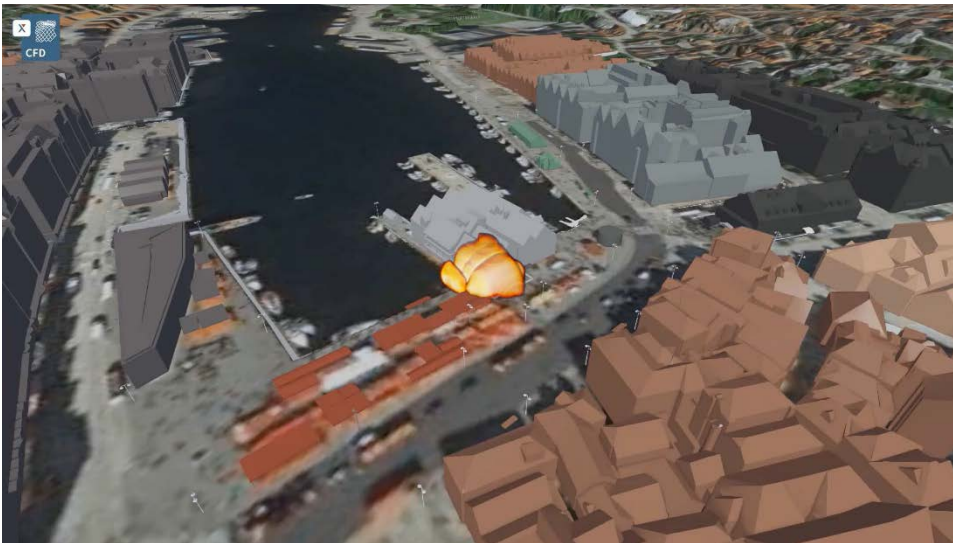
Figur 17: Utbredelse av flammefront etter antent maksimal brennbar gassky
