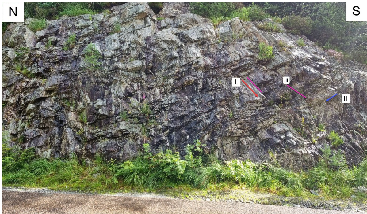
Figur 4. Observerte sprekkesett I, II og III ved skjæring langs nedenfor Folldalsheia 3D.
