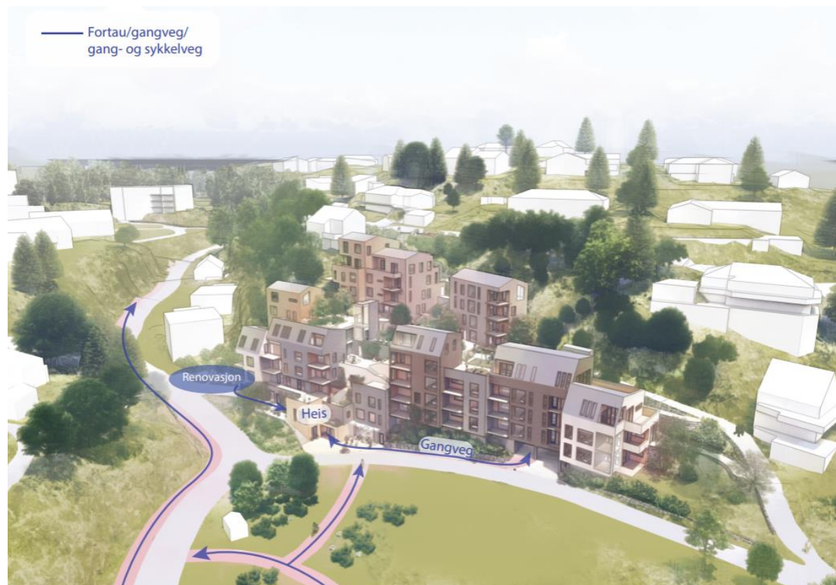
Figur 13: Utklipp fra illustrasjonsmodell som viser gangveger med blå piler, og renovasjonsområde i blå sirkel.
