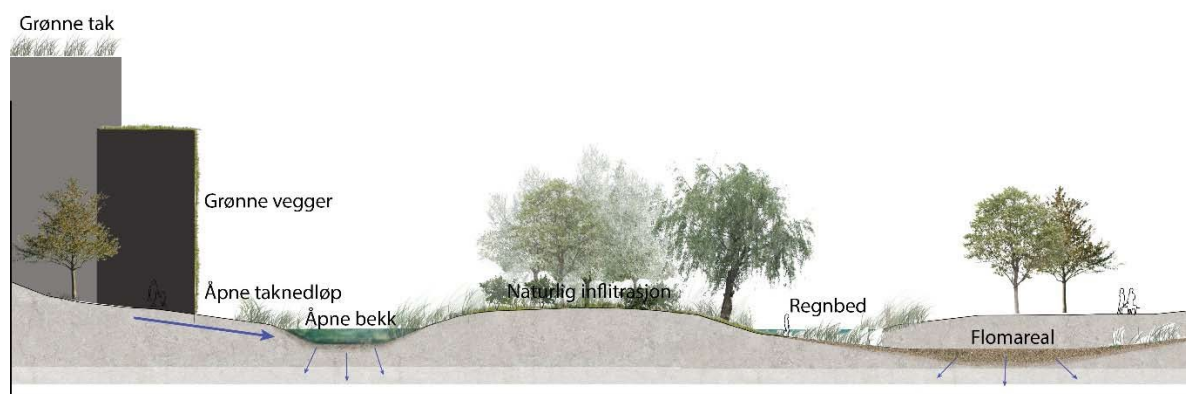
Figur 12 Lokale løsninger for overvann (Norsk vann 2008)
