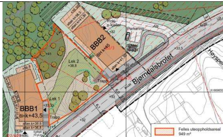
Figur 8-25 Illustrasjon som viser foreslått bearbeidet lekeareal med grønn skravur og der rød skravur viser arealet som er regnet med i felles uteoppholdsareal mellom leilighetsbyggene.
