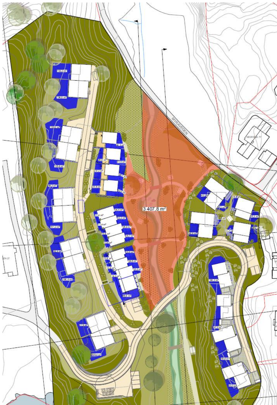
Figur 4-18: MUA-plan. Felles uteoppholdsarealer ihht. MUA-krav er vist i rødt. Private uteoppholdsarealer ihht. MUA-krav er vist i blått. Kime Arkitektur og Landskap AS
