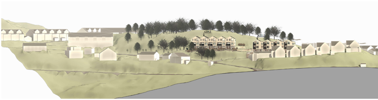
Figur 18. Illustrasjon: Oppriss 2 gjennom Sanddalsringen viser hvordan utformingen av prosjektet er tilpasset omkringliggende bygningstypologi i form av volumoppdeling, skala og takform. Forum Arkitekter AS.
