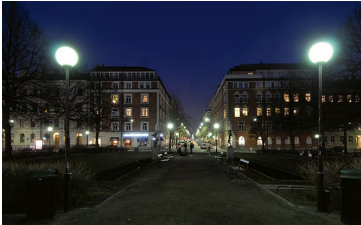
Figur 9: Mariatorget i Stockholm før oppgradering av belysning. Blendende lyskilder med diffus lysfordeling som gir for mye lys mot himmelen og lite lys mot bakken. Kilde: ÅF Lighting (nå Light Bureau part of AFRY)
