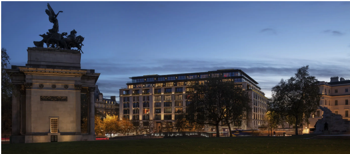
Figur 8: Fasadebelysning, i samspill med lys på utvalgte trær og statuer er med på å skape oversikt og helhet; Her er det satt fokus på opplevelse, visuelle, estetiske og miljøkrav fremfor høye lysnivåer; The Peninsula London, Kilde: Speirs & Major.
