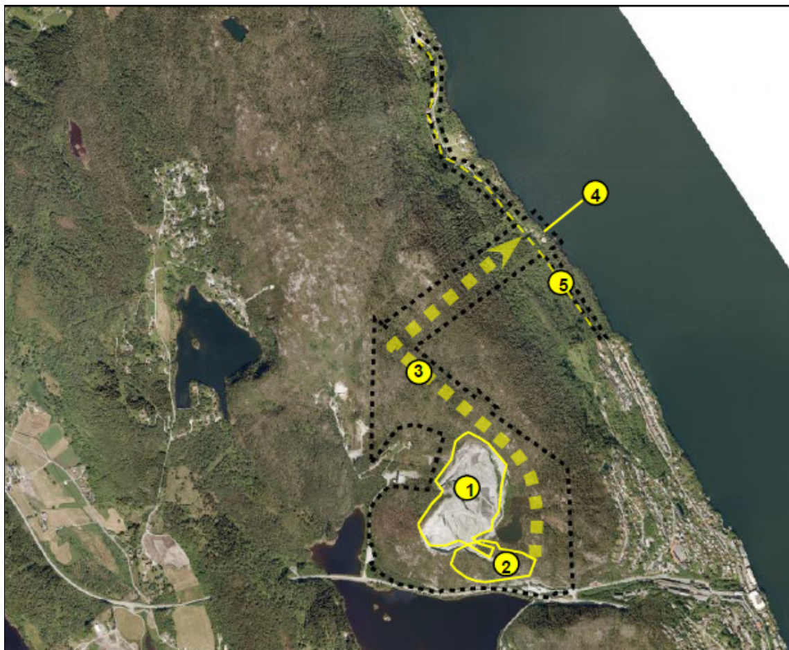
Figur 1. Planområdet for utvidelse av Arna Steinknuseverk med spesifiserte delområder: Eksisterende dagbrudd med buffersoner rundt (nr. 1), fjellanlegg under bakken (nr. 2), tunnel for massetransport (nr. 3), utskipingskai (nr. 4) og sykkeltrasé (nr. 5) (kilde: Planprogrammet).
