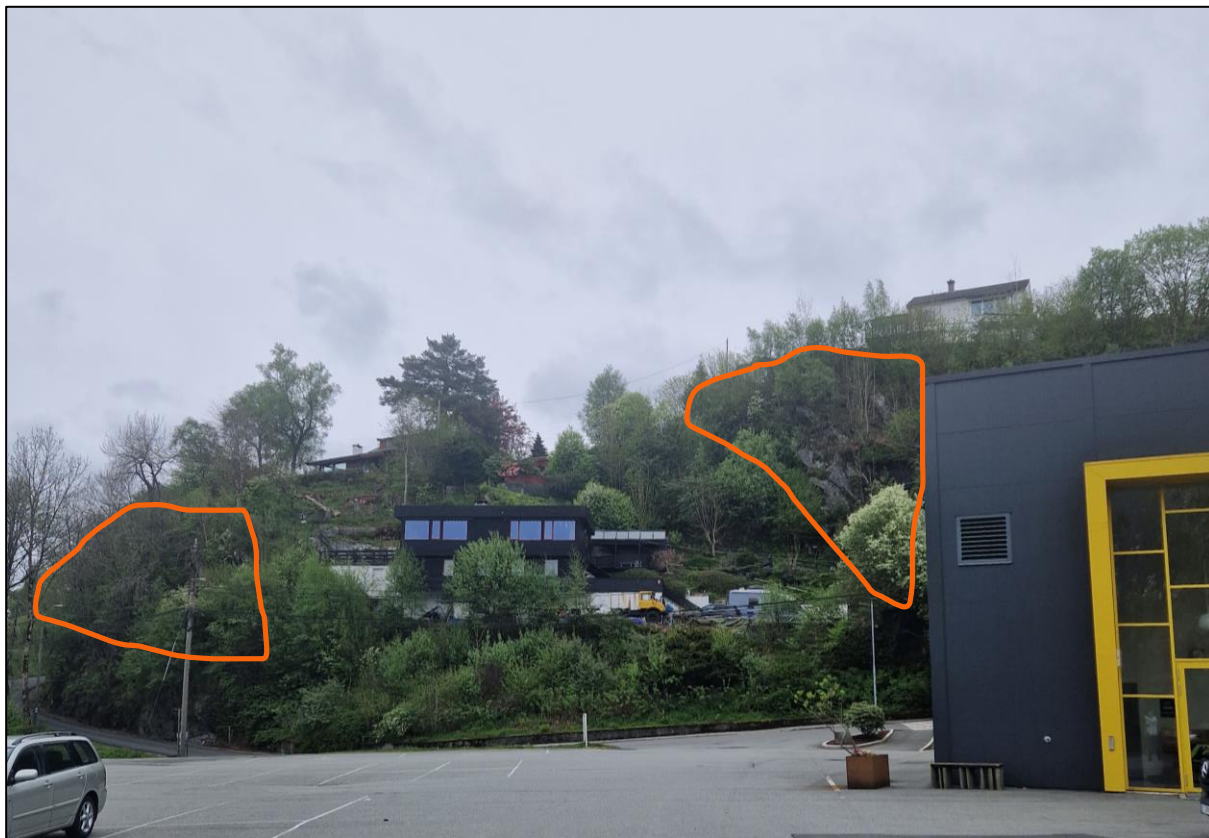
Foto 5. Potensielle løснеområder (merket med oransje) for steinsprang i nordøstlig del av påvirkningsområde. Bildet tatt mot nordvest.
