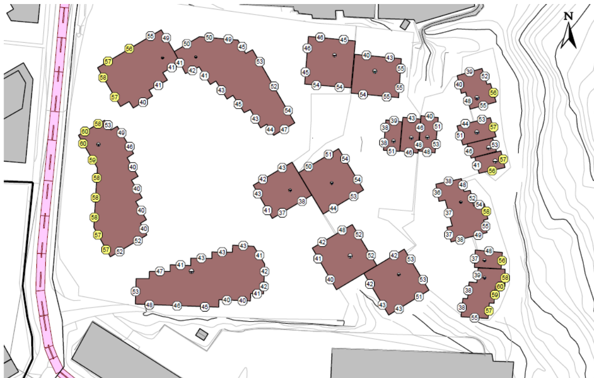
Figur 5-45 Utendørs støynivå Lden ved fasader. Figuren viser høyeste nivå uavhengig av etasje høyde. Sweco
