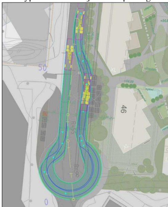
Figur 5-41 Kjørerute via snulomme for renovasjonsbil til hentepunktet. Multiconsult Tilkomst for renovasjonsbil til hentepunkt løses via Sandslåsen fra nord, og snur i planlagt snusløyfe. Snusløyen er regulert i planforslag Plan-ID 70380000 (Sandslåsen 59, vedtatt 22.12.2023). Foreslått løsning for renovasjon benytter vegareal i Sandslåsen og snusløyfe
