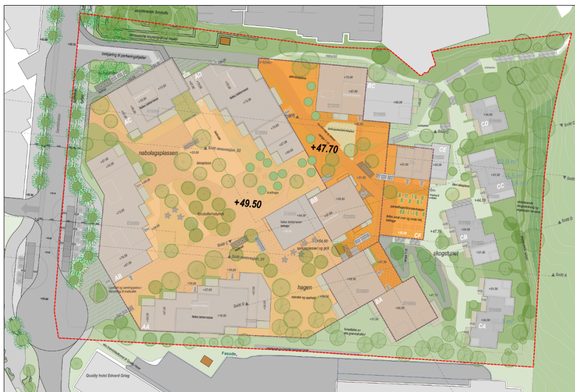
Figur 11: Skisse som viser lokasjon av planlagt parkeringskjeller. Kt. +49,5 er gulv P-kjeller. Innvendig tak er +51,9. Betongdekke er 0,3 meter og isolasjon oppå er inntil 0,3 meter. (Kilde: LINK Arkitektur)
