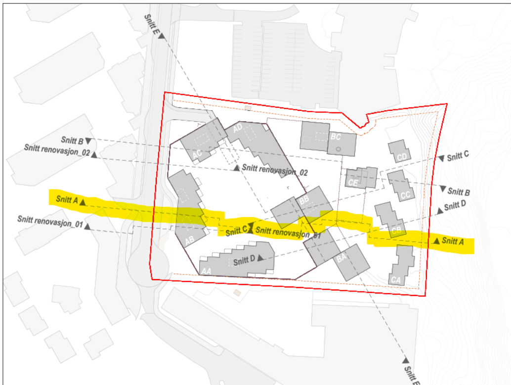
Figur 12: Skisse som viser lokasjon for snitt A-A for å vise parkeringskjelleren. (Kilde: LINK Arkitektur)
