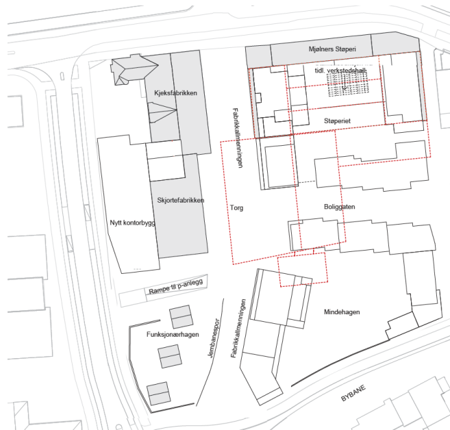
Figur 4-44. Oversikt over kulturminner innenfor planområdet som bevares (grå farge). Bygg som ikke bevares er vist med rød stiplet linje.
