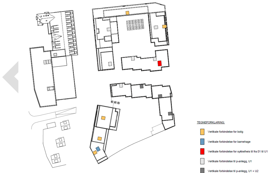
Figur 4-37. Figuren viser vertikalforbindelser i bygningene. Bygninger merket med grå forbindelser har direkte heisforbindelse til kjeller.
