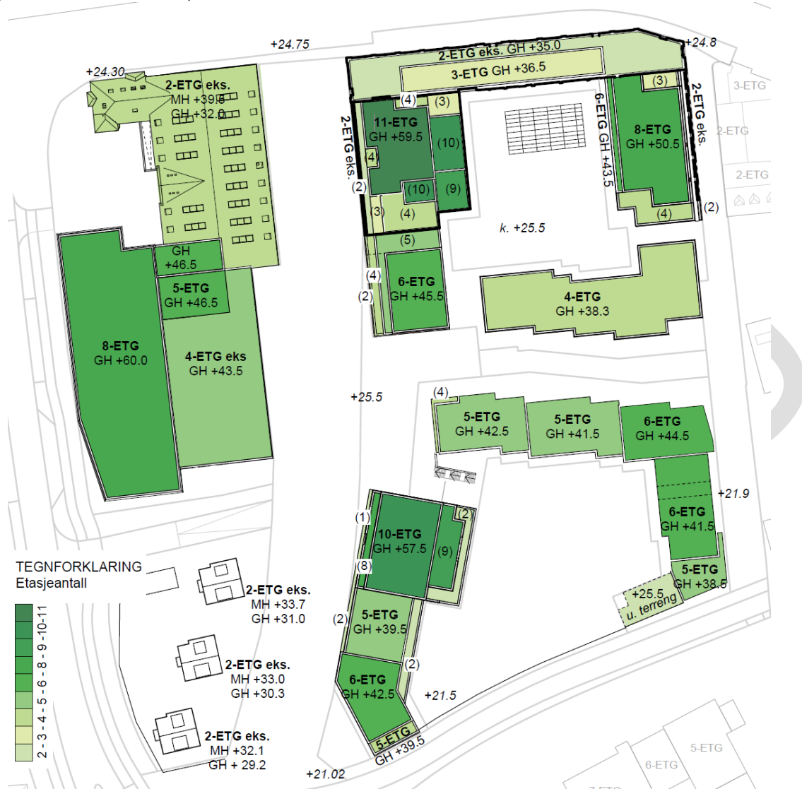
Figur 4-11. Byggehøyder vist som etasje- og kotehøyder.
