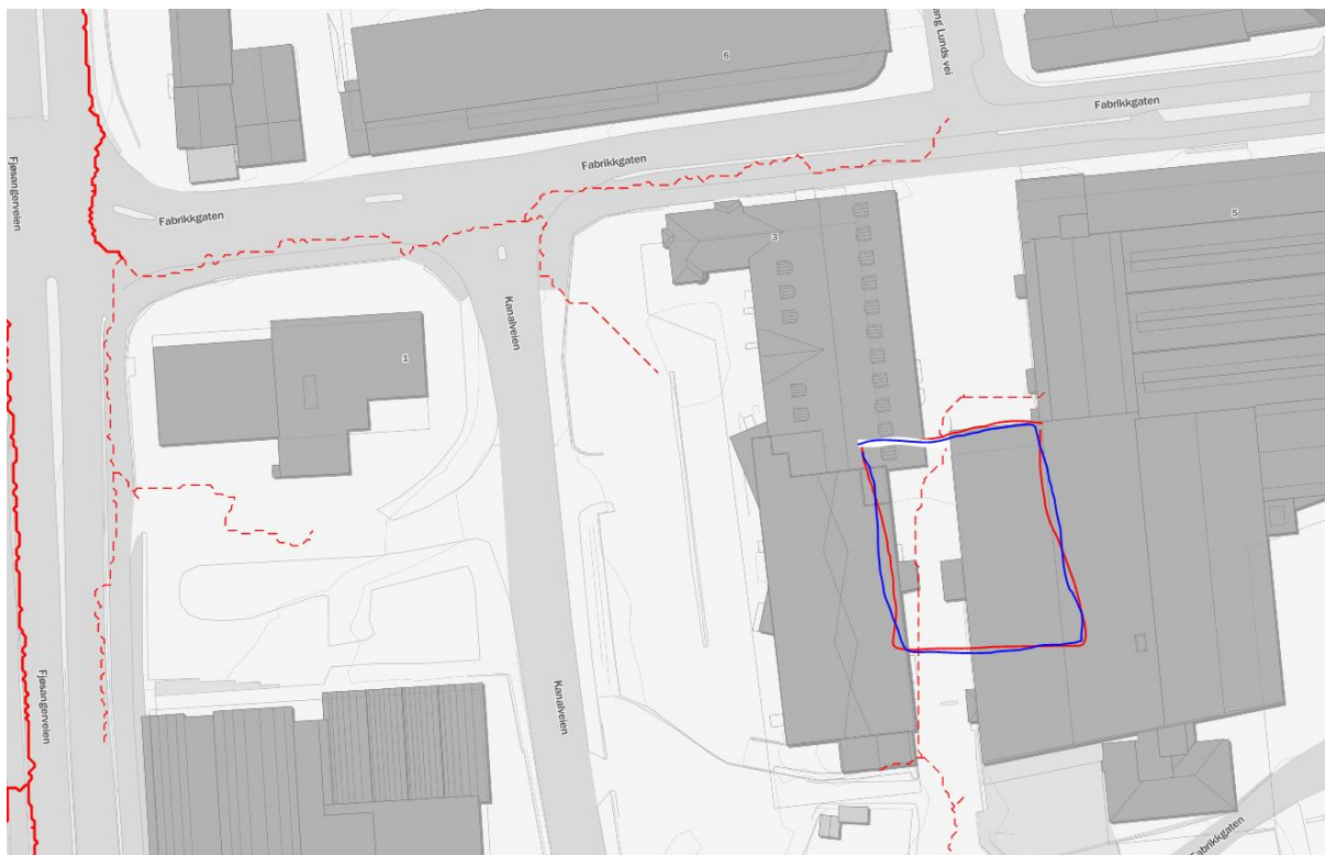
Figur 4-43. Dagens avrenningsmønster og mer-areal i forhold til dagens avrenning mot Fabrikkgaten (blå firkant).
