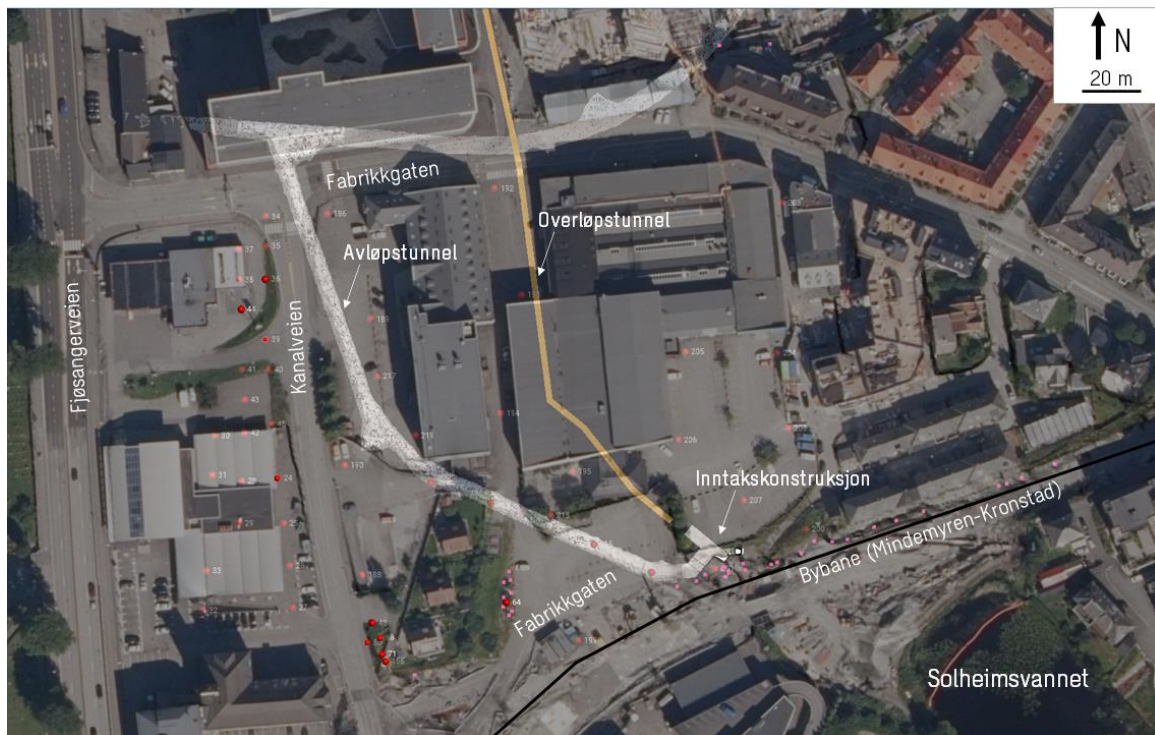
Figur 5 Utklipp fra flyfoto/modell med oversikt over plassering av avløpstunnel, overløpstunnel og inntakskonstruksjonen. Grunnundersøkelsespunkt (røde punkt) og punkt med observert berg i dagen (rosa punkt) er vist for å tydelig gjøre datagrunnlaget for modellering av teoretisk/anslått bergoverflate over tunnelen.
