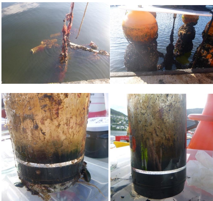
Figur 4 Bilder fra feltarbeid 18.08.17. Over: Den øverste fellen inneholdt ikke materiale. Under venstre: Sedimentfelle 3-2. Under høyre: Sedimentfelle 3-1. Rørene til de to nederste sedimentfellene var også noe begrodd (alger, etc.), men inneholdt sedimentert materiale.
