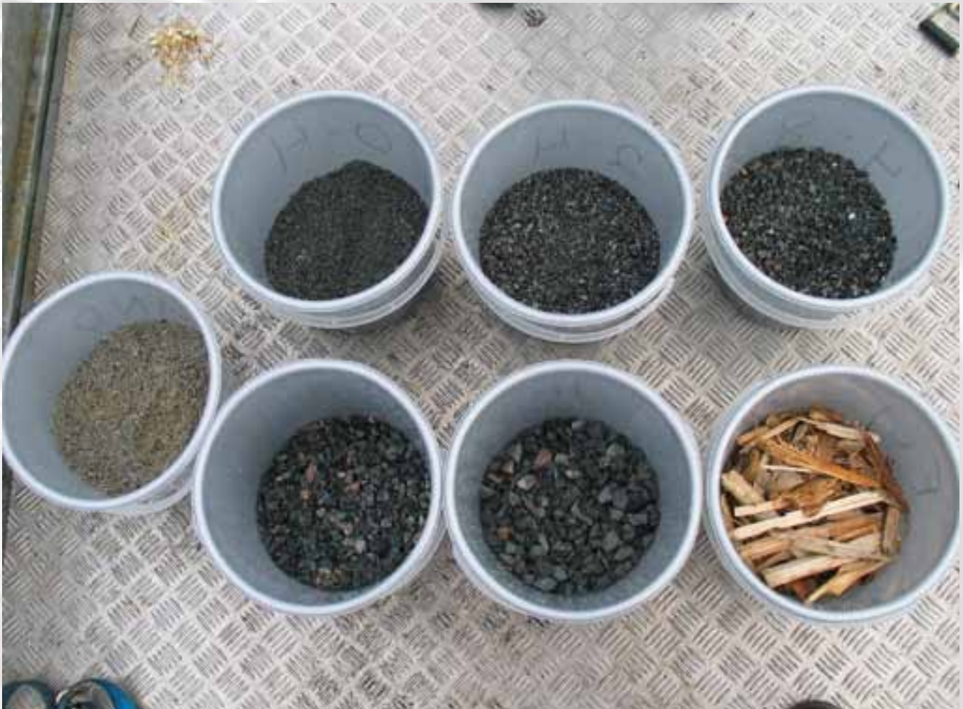
Eksempel på godt og mindre godt filtermateriale. Bøtta med støpesand er uegnet da den inneholder finstoff. Grovsingel beskytter rørene og letter vanntilstrømningen, men har ingen filtreringseffekt. Foto: Bente J. Øpstad.
