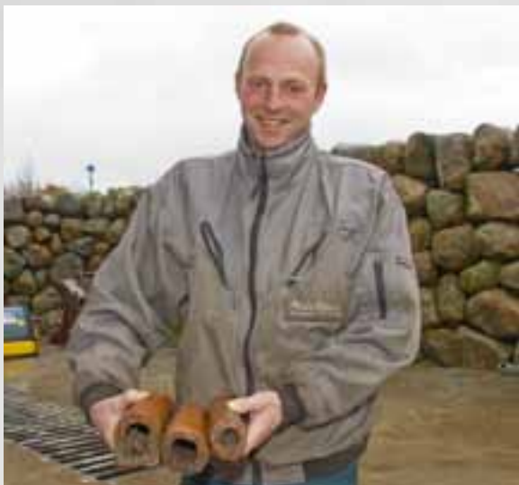
Nils Oma med døme på eldre grøfterøyr. Tegl i ulike dimensjonar, med ovalt eller rundt løp.
