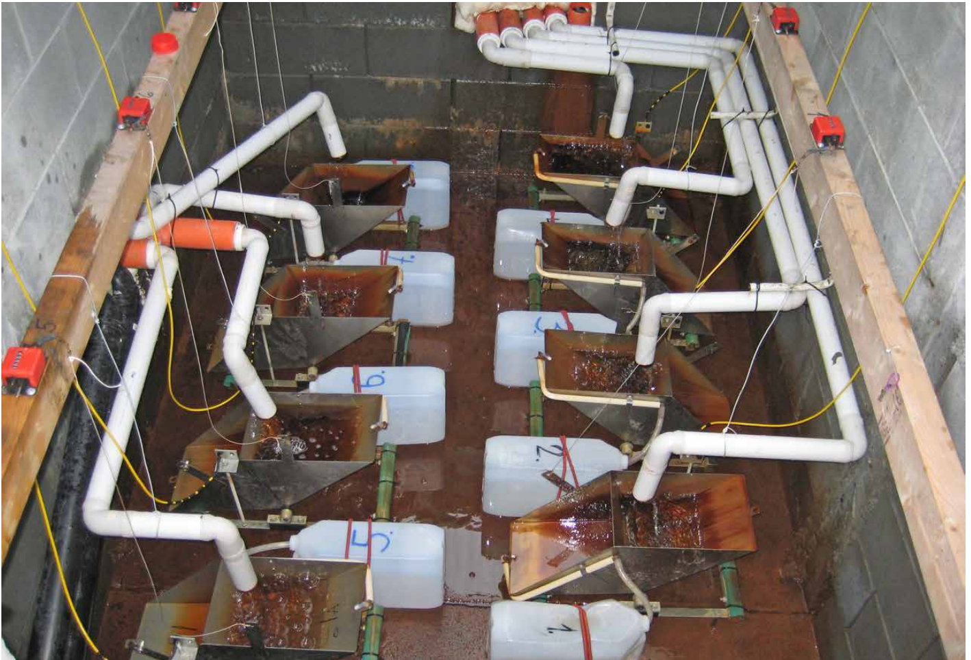
Måling pågår: Målehuset der grøfterøyra kjem inn og der det er vippekar med instrumentering for måling av grøfteavrenning og uttak av vassproporsjonale prøver til kjemisk analyse. Foto: Konrad Furset.
