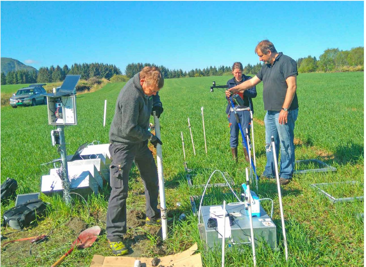
Feltarbeid: Innstallasjon og utprøving av utstyr for måling av klimagassutslepp på grøfta og omgravd myr på Fræna i Møre og Romsdal. Foto: Synnøve Rivedal.
