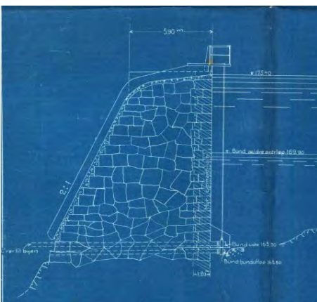
Figur 55 og 56: Tverr- og lengsesnitt over inntaksdammen i Skredderdalen slik den stod ferdig i 1924. Utsnitt fra «Kart over indtaksbassæng i Skrædderdalen» Bergen Vand- og kloakvæsen 1/12-1924
